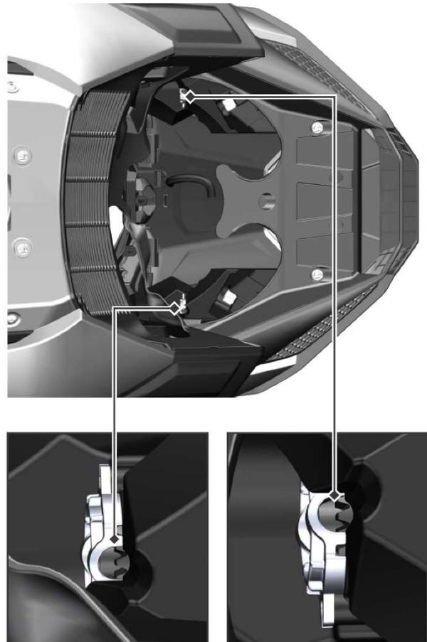
2. Utilice un destornillador de estrella de 6x150-200 e introdúzcalo en el orificio de ajuste. Disminuya la altura del haz girándolo en sentido antihorario y aumentelo en sentido horario. Al ajustar, debe girar el manillar en la dirección correspondiente para disponer de más espacio para facilitar la operación.
