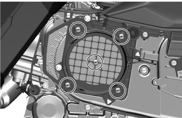
4. Retire los cinco tornillos, retire el elemento filtrante del filtro del aire de la transmisión y cámbielo por uno nuevo.
