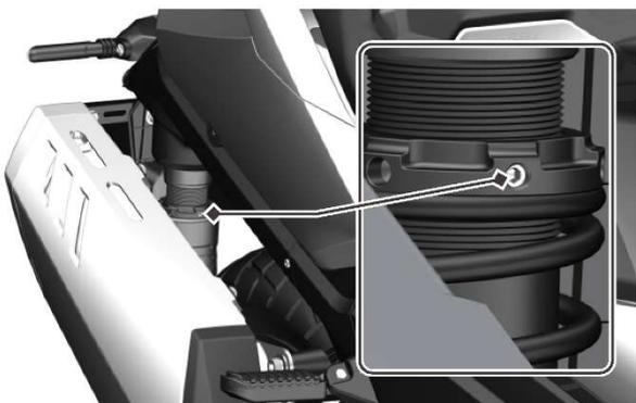
Apriete el tornillo de bloqueo después del ajuste y continúe apretando de 1/2 a 3/4 de vuelta cuando sienta resistencia.
