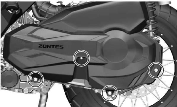
3. Retire los cuatro tornillos y saque la tapa izquierda de la transmisión.
