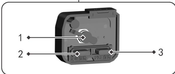
1: Toma de carga en corriente continua para la carga de la batería
