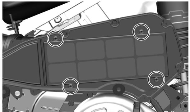
6. Retire los 4 tornillos, saque el elemento filtrante, y sople la suciedad desde el lado interior del elemento filtrante con una pistola de aire comprimido.
