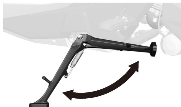
Cuando el caballote lateral está extendido o apoyado, el interruptor de seguridad del caballote lateral cortará el encendido y el motor se parará. Tampoco funcionará el motor de arranque hasta que lo recoja.
