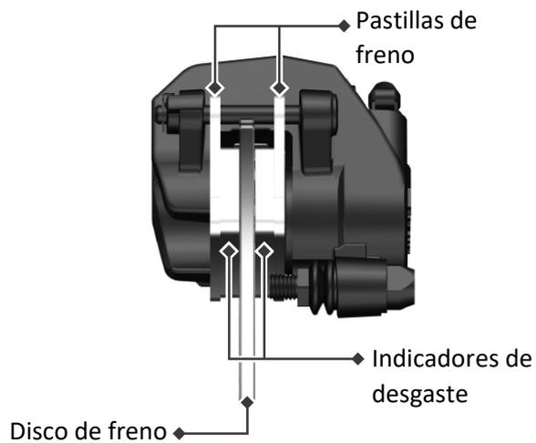
En la rueda delantera, compruebe las pastillas de freno desde la parte delantera de la pinza de freno (recuerde comprobar las pinzas de freno izquierda y derecha).
