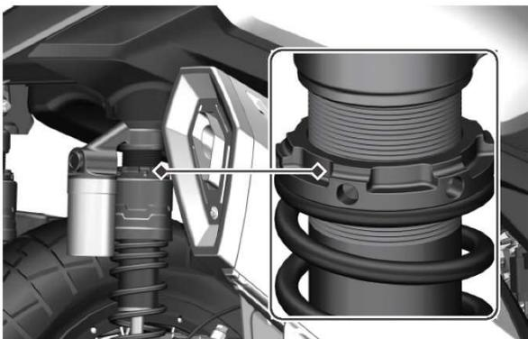
Actuando sobre el mando de la parte superior del amortiguador, gire el mando de ajuste de la precarga en el sentido horario y aumentará la fuerza de precarga del muelle (se endurece). La precarga del muelle se reduce (más blanda) girando el mando de precarga del muelle en sentido antihorario.
