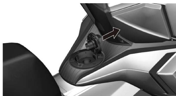
El depósito de gasolina se encuentra delante del asiento. Al abrir el tapón del depósito de gasolina, compruebe que el interruptor cortacorrientes del motor esté apagado. El vehículo debe estar activado para abrir el tapón del depósito de gasolina. Mueva hacia atrás la pestaña pequeña para abrir el tapón del depósito de gasolina.
