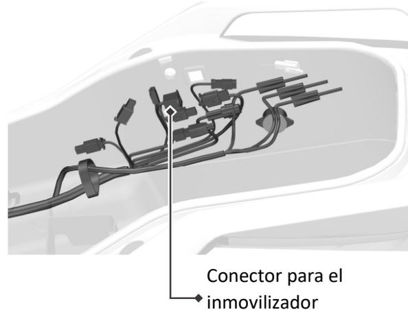
El conector para el inmovilizador se encuentra por el lado derecho de la parte trasera y es visible cuando se retira el recipiente del compartimento de carga.
