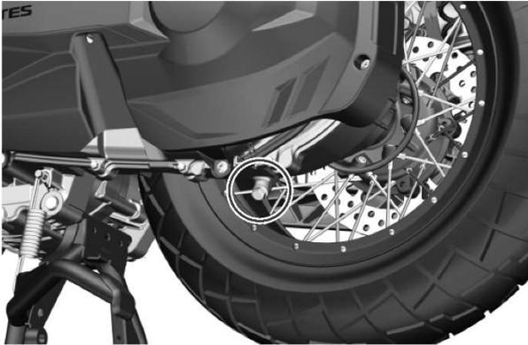
1. Arranque el motor, ruede el vehículo unos minutos, deje que aumente la temperatura del aceite de la caja reductora luego pare el motor.
