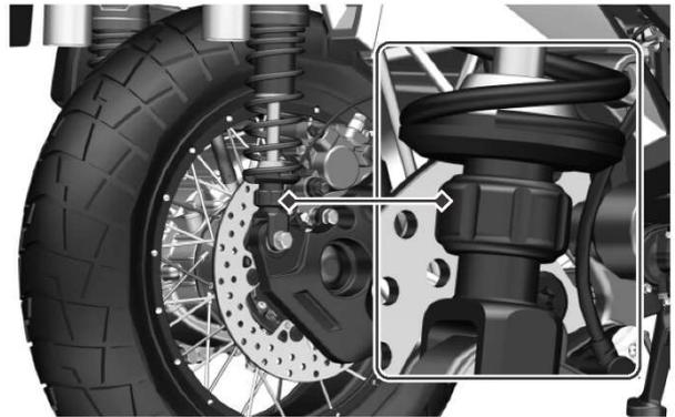
Hay un segundo mando de ajuste en los amortiguadores traseros que ajusta el hidráulico en extensión. Girando en sentido antihorario aumentará la resistencia a la extensión y girando en sentido horario reducirá la resistencia a la extensión. El ajuste estándar es de 2 clicks desde abierto (desenroscado totalmente).
