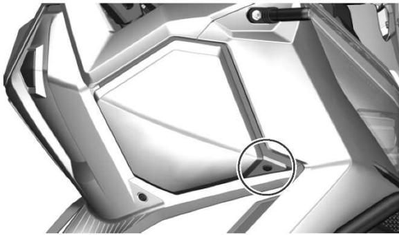
Desmonte el remache de la esquina saliente en la tapa de la guantera derecha y estire hacia fuera para extraer la tapa.
