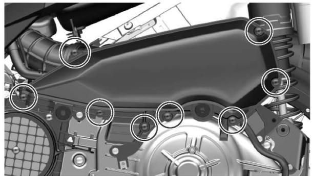
5. Retire los 10 tornillos de las figuras anteriores y retire la tapa del filtro del aire del motor.
