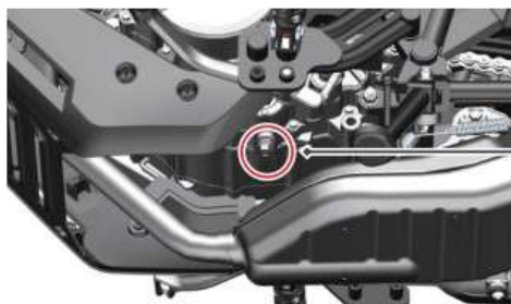
Tornillo de drenaje del aceite motor
