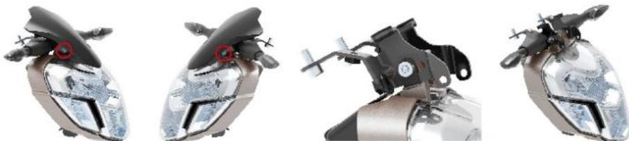
Ajuste de la altura del haz del faro
