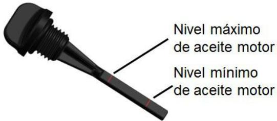
Para conseguir la máxima durabilidad del motor, es muy importante utilizar aceite motor de alta calidad y cambiar el aceite según se indica en la tabla de mantenimiento. Comprobar el nivel de aceite y cambiarlo periódicamente son dos importantes tareas del mantenimiento de la motocicleta.
