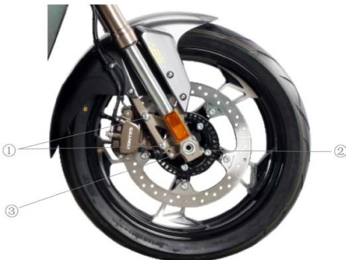
Par de apriete del eje delantero: 65 Nm
