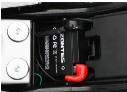
La batería se encuentra debajo del asiento del piloto. Se trata de una batería de litio sin electrolito y sin mantenimiento. Haga la primera carga con un cargador específico para batería de litio. Después de montarla, está lista para su uso.
