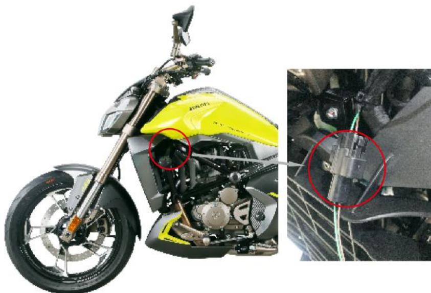
La motocicleta cuenta de serie con un conector situado bajo el depósito de gasolina por el lado izquierdo como muestra la imagen. El conector es impermeable y suministra energía sólo cuando el motor está en marcha, pudiendo conectarse faros auxiliares sin dañar los circuitos eléctricos originales.
