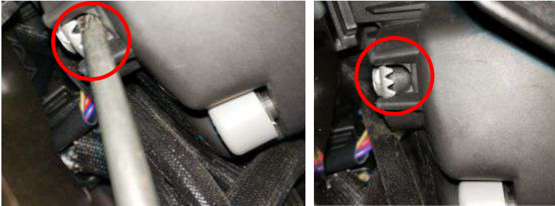
Ajuste de la altura del haz del faro
