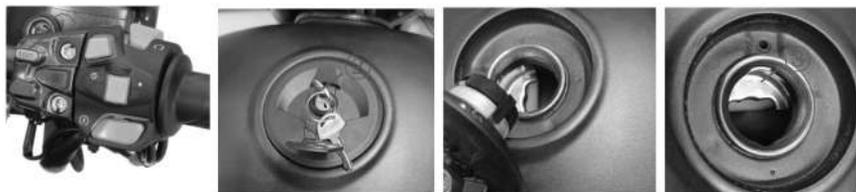
El depósito de gasolina se encuentra delante del asiento. Para repostar gasolina deberá abrir la tapa de acceso al tapón. Asegúrese de que el motor esté parado, y pulse el botón de apertura de la tapa del depósito de gasolina, la tapa se abrirá automáticamente, gire el tapón del depósito de gasolina en sentido antihorario. Para cerrar el depósito, siga el orden opuesto al descrito.
