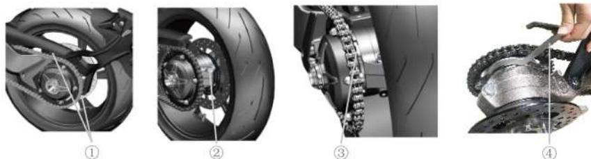
1. Use una llave Allen de 6 mm para retirar los tornillos M8 (1) mostrados en la Figura, luego retire cuidadosamente el soporte de la matrícula sin tirar del cable.
