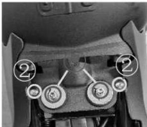
Retire los dos tornillos M6 ② que fijan las cubiertas derecha/izquierda al depósito.
