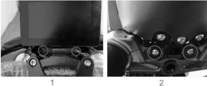
Ajuste de la altura del haz del faro
