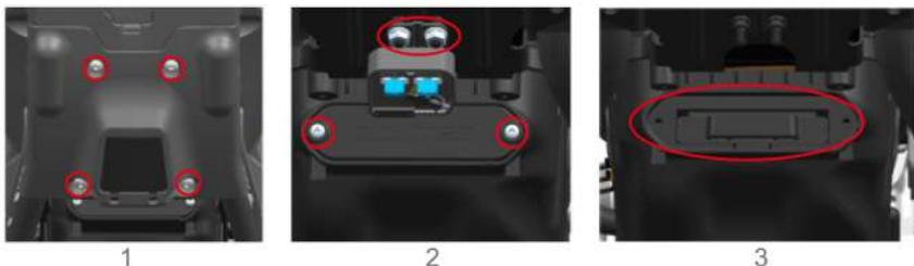
El filtro del aire se encuentra bajo el asiento, Si el filtro del aire está sucio, puede hacer que se obstruya el paso del aire de admisión, baje la potencia y aumente el consumo de combustible. Complete los siguientes pasos para realizar la limpieza del filtro del aire.
