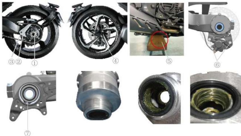
1. Retire el pasador de la tuerca almenada del eje trasero (1), y luego afloje la tuerca M35 (par de apriete 200 Nm). Cuando lo afloje, el buje del disco de freno debe estar apretado para evitar que gire. Tenga en cuenta que no es necesario retirar la tuerca M35.
