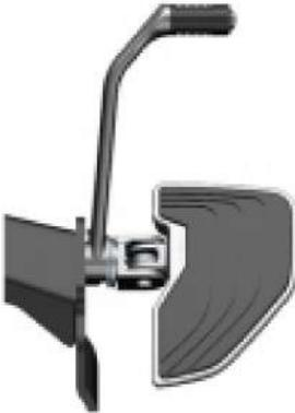
Presione el pedal del freno trasero, la rueda trasera frenará y se iluminará la luz de freno a la vez.
