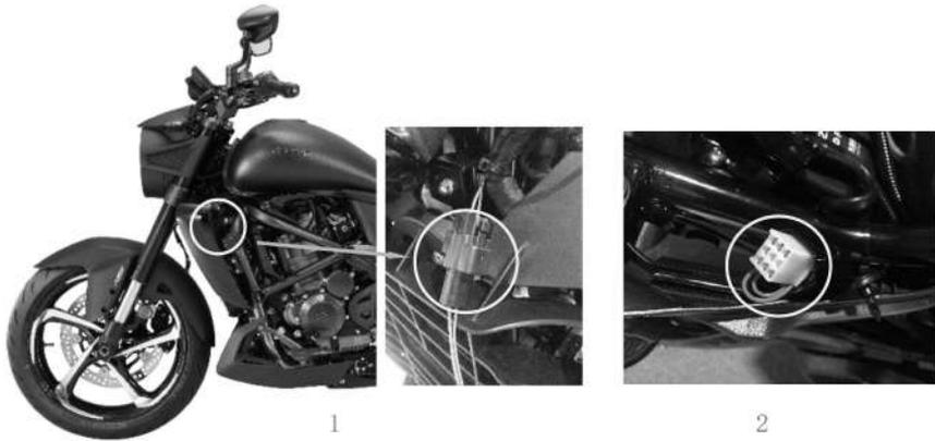
La motocicleta cuenta de serie con un conector situado bajo el depósito de gasolina por el lado izquierdo como muestra la imagen. El conector es impermeable y suministra energía sólo cuando el motor está en marcha, pudiendo conectarse faros auxiliares sin dañar los circuitos eléctricos originales.
