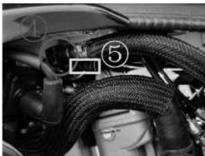
Retire el tubo de gasolina a alta presión ④ y el conector de la bomba de gasolina ⑤.
