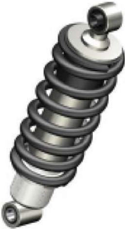
El muelle del amortiguador trasero se ajusta según las necesidades de conducción, la carga y el estado de la carretera. Para ello solo necesita detener la motocicleta con el caballete lateral. Ajuste la precarga del muelle a la posición deseada. La rigidez disminuirá cuando lo ajustemos hacia abajo y aumentará cuando la ajustemos hacia arriba.
