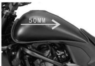
Sujete el depósito con ambas manos y muévelo hacia atrás unos 50 mm, luego retire el depósito de gasolina de la motocicleta y guárdelo en una zona segura.
