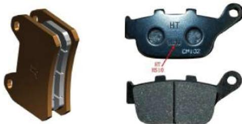
Compruebe si las pastillas de freno delanteras y traseras están desgastadas o próximas a su límite de desgaste. Si han alcanzado el límite de desgaste (el material ha alcanzado el fondo de las ranuras) confíe el cambio de pastillas a un Vendedor Autorizado Zontes que cambiará las dos pastillas de una misma pinza a la vez.
