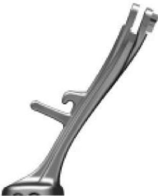
Cuando use el caballete lateral, al desplegarlo se cortará el encendido del motor a no ser que mantenga accionada la maneta del embrague con el cambio en punto muerto.
