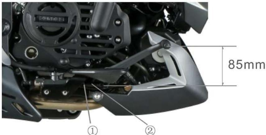
1. Afloje la contratuerca (1), gire el tornillo (2), el pedal de freno debe encontrarse 85 mm por debajo de la punta del pie derecho.
